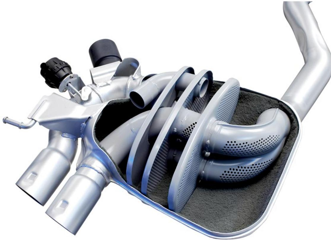
vuelven a encontrarse, se superponen y se anulan mutuamente. Durante la estrangulación, las perforaciones y los estrechamientos de los tubos garantizan la división y amortiguación del flujo de gases de escape.
