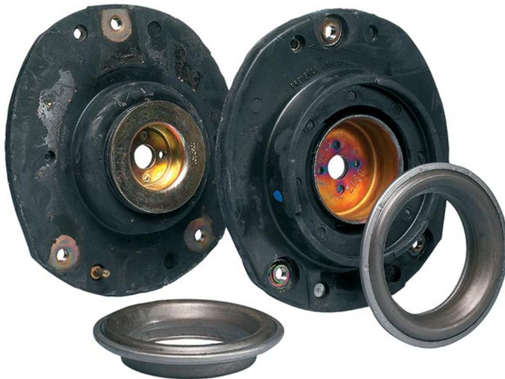
Con el paso del tiempo, el diseño del soporte de suspensión se ha ido adaptando a las necesidades del mercado. Las columnas McPherson se utilizan sobre todo en los coches modernos. Se trata de una forma especial de suspensión de ruedas para el eje delantero. Para apoyarlos en la carrocería, se utilizan soportes de puntales que contienen un rodamiento de bolas. Éste es capaz de absorber grandes fuerzas, además de permitir que el puntal gire suavemente.
