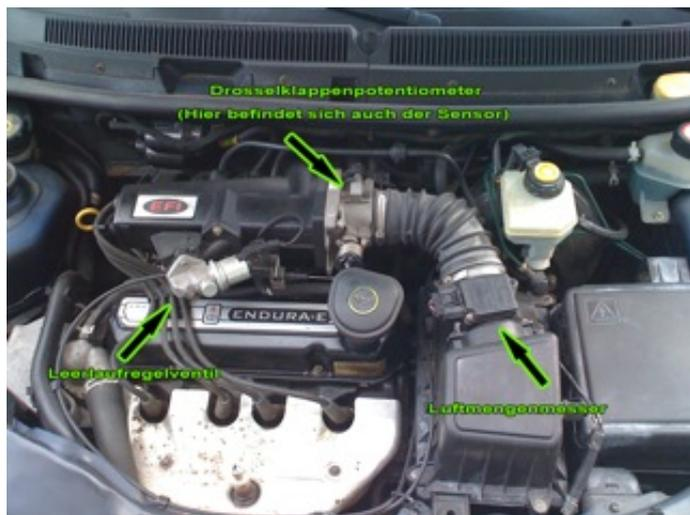
Los sensores de la válvula de mariposa están fijados al eje de la válvula de mariposa. Su función es detectar el ángulo de apertura de la válvula de mariposa y transmitir esta información a la unidad de control del motor en forma de señal eléctrica. La electrónica del motor utiliza este valor para calcular la cantidad de combustible que debe inyectarse. Esto depende de otros factores como la temperatura del motor, la presión del aire y el régimen del motor.
