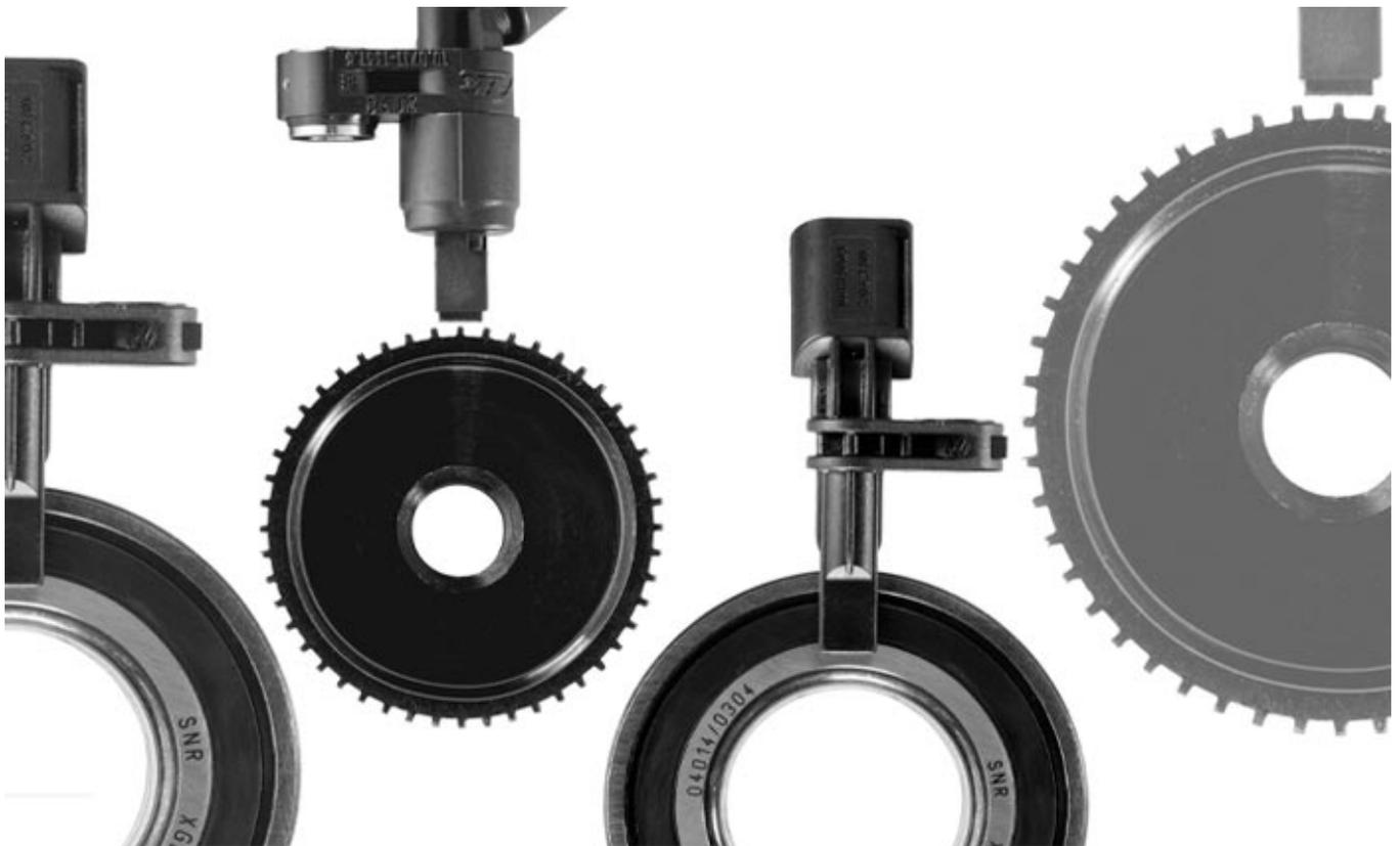
El ABS se ha ampliado para incluir las funciones del ESP® o del control antideslizamiento (ASR). Esta ampliación obliga a utilizar sistemas de sensores que emiten una señal utilizable a velocidades muy bajas, prácticamente hasta que el vehículo se detiene. En este caso se utilizan sensores activos. Funcionan según el principio magnetorresistivo: se alimentan con tensión y captan su señal de una denominada "rueda codificadora", un generador de impulsos magnéticos.
