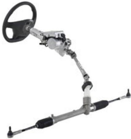
La dirección asistida eléctrica con accionamiento por columna (Column Drive EPS) es una variante en la que el par de dirección adicional se transmite al eje de dirección a través de un engranaje helicoidal en la columna de dirección. Este sistema se utiliza en vehículos más pequeños con poco espacio en el compartimento del motor.
