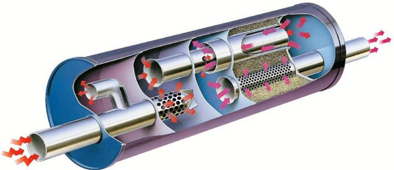
Todo motor de combustión produce lo que se conoce como "ruido de escape" debido a la salida pulsante de gases de los cilindros. Este ruido se amortigua reduciendo la energía sonora del flujo de gases de escape. Para ello existen dos métodos: la absorción y la reflexión del sonido. Estos procesos tienen lugar principalmente en un silenciador. Sin embargo, los resonadores y las chapaletas de
