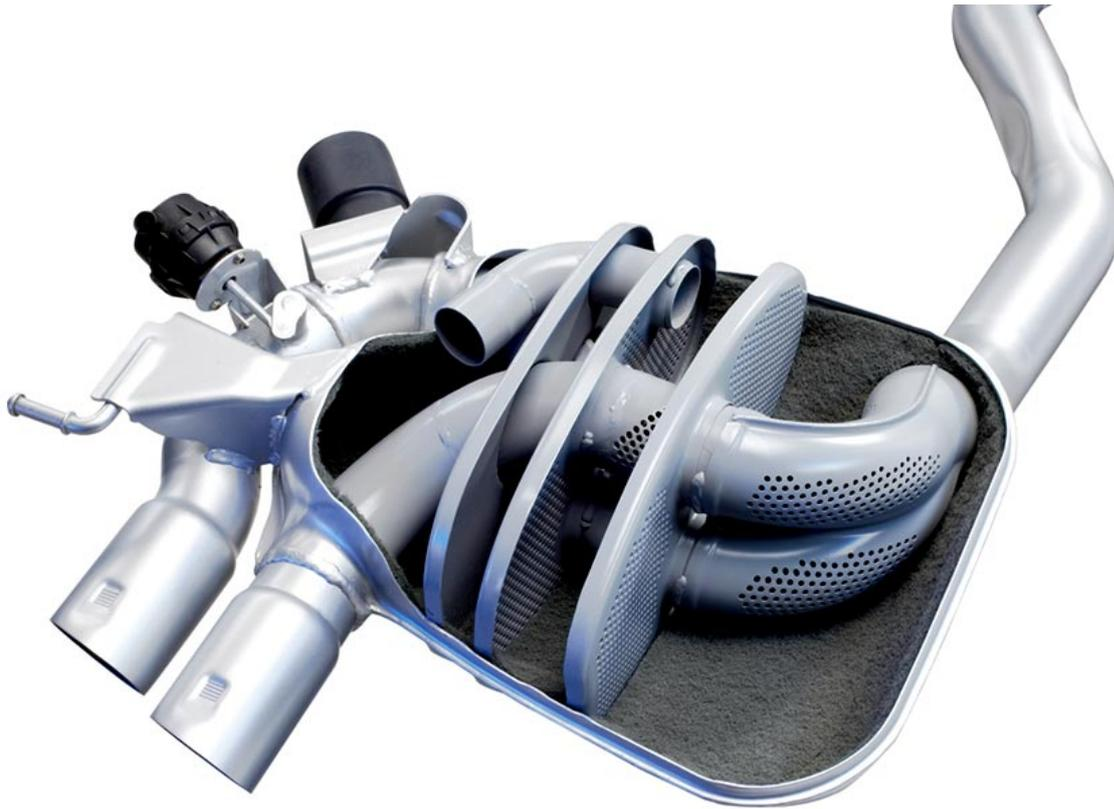
En los motores en V, cada una de las dos filas de cilindros tiene su propio conducto de escape. Estos permanecen separados hasta los tubos de escape o se juntan previamente. Esto último tiene lugar en un silenciador trasero común.
