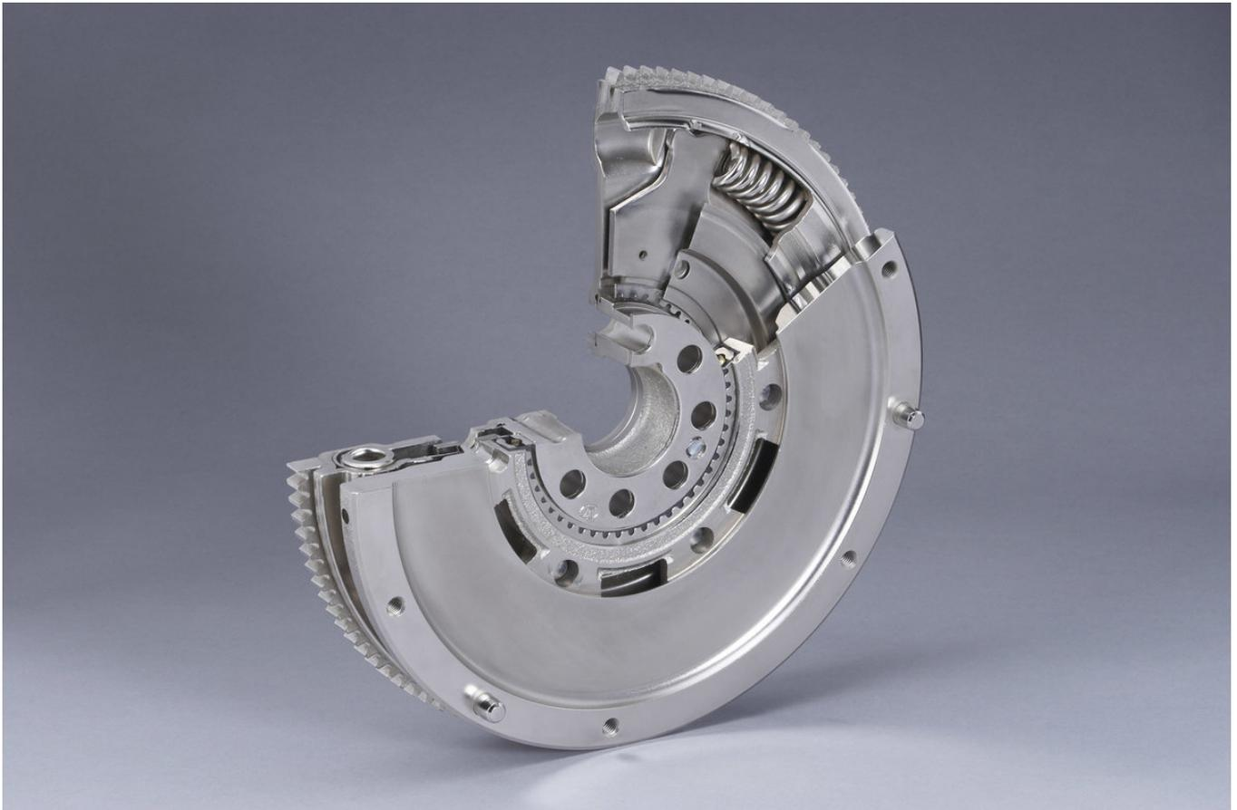
Un volante bimasa es un volante con un amortiguador de vibraciones de torsión integrado. Evita que las vibraciones torsionales del motor alternativo se transmitan a la transmisión. El DMF desacopla la masa primaria del volante procedente del motor y la masa secundaria del volante procedente de la transmisión mediante un sistema de amortiguación por muelles. Este proceso absorbe las vibraciones torsionales y el ruido resultante casi por completo en la cadena cinemática.
