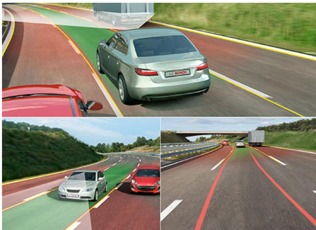
Los sistemas de advertencia de abandono de carril utilizan una pequeña cámara de vídeo montada detrás del parabrisas para detectar las marcas del carril delante del vehículo y compararlas con la posición del vehículo en el carril: el sistema evalúa las diferencias de contraste entre la superficie de la carretera y las marcas del carril. Si el sistema reconoce que no se ha alcanzado una distancia mínima definida hasta el límite del carril, se activa.
