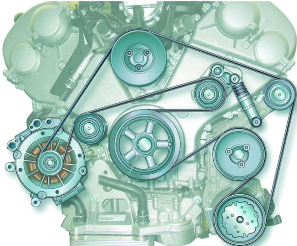
Debido a la creciente demanda de confort en los vehículos de motor de hoy en día, la proporción de electrónica, y por lo tanto la necesidad de energía eléctrica en el coche, ha aumentado considerablemente. Como resultado, una correa trapezoidal por sí sola ya no suele ser suficiente para accionar los alternadores más potentes y otras unidades auxiliares como el compresor del aire
