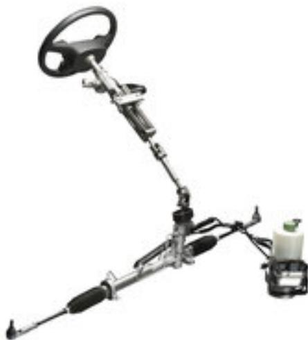
En un sistema de dirección asistida electrohidráulica, también conocido como dirección hidráulica accionada eléctricamente (EPHS), la bomba de dirección asistida accionada por correa se sustituye por una bomba hidráulica eléctrica, el llamado conjunto motor-bomba (MPA).
