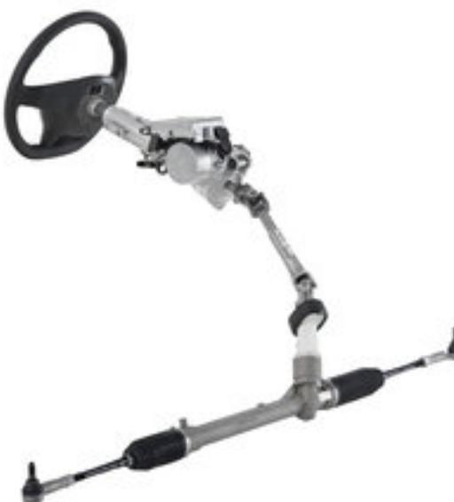
La dirección asistida eléctrica con accionamiento por columna (Column Drive EPS) es una variante en la que el par de dirección adicional se transmite al eje de dirección a través de un engranaje helicoidal en la columna de dirección. Este sistema se utiliza en vehículos más pequeños con poco espacio en el compartimento del motor.
