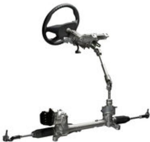
Los sistemas de dirección asistida eléctricamente, también conocidos como dirección asistida eléctricamente (EPS), prescinden por completo del fluido hidráulico. En estos sistemas, el movimiento de la dirección se apoya en un motor eléctrico.
