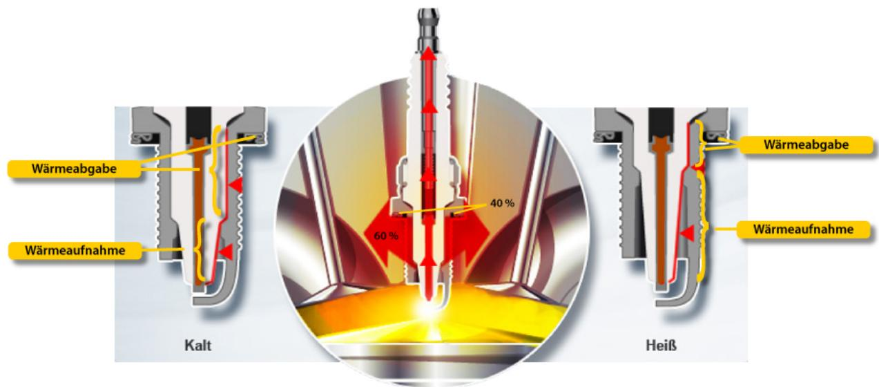
El desarrollo del calor varía mucho de un motor a otro. Los motores turboalimentados, por ejemplo, se calientan mucho más que los no turboalimentados. Por este motivo, para cada motor existe una bujía que puede liberar una cantidad de calor definida con precisión a la culata y garantiza el mantenimiento de la ventana de temperatura óptima. El denominado valor térmico informa sobre la capacidad de carga térmica de una bujía. Todos los fabricantes de bujías lo denominan de forma diferente.
