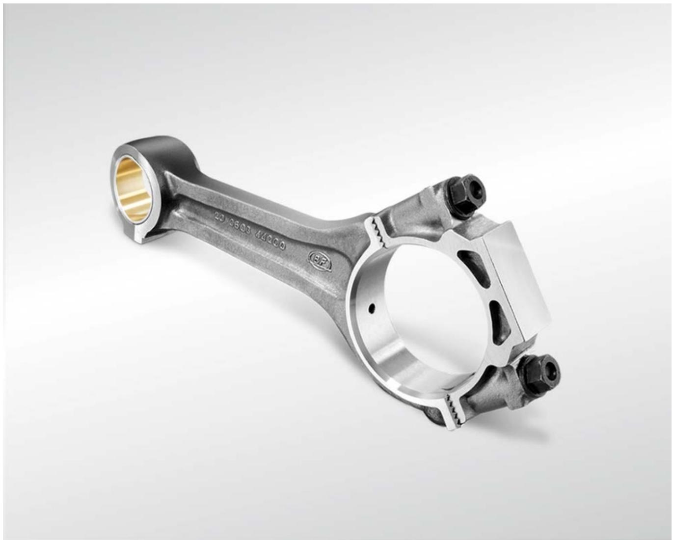
La biela está montada sobre la muñequilla del cigüeñal con un cojinete liso. La tapa del cojinete de biela se fija a la base de la biela con pernos de expansión. En la mayoría de los casos, la biela está perforada o diseñada con un canal de aceite moldeado para suministrar lubricante al bulón del pistón.
