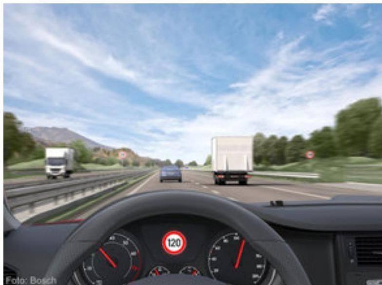
El reconocimiento de señales de tráfico utiliza una cámara de vídeo orientada hacia delante montada en la zona del espejo retrovisor para detectar permanentemente las señales de tráfico en el tráfico rodado.
