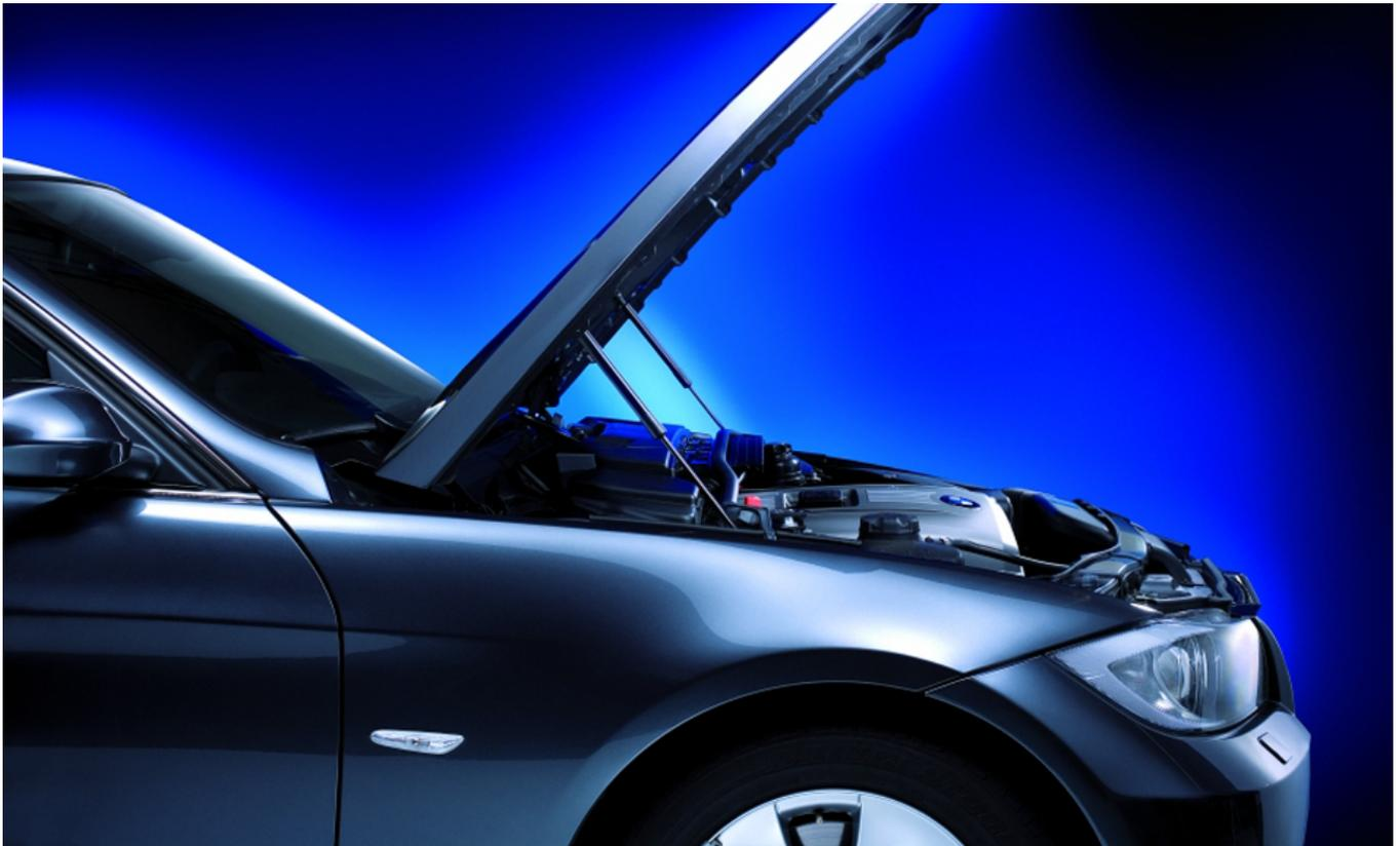
Los amortiguadores de gas permiten abrir y cerrar sin esfuerzo y cómodamente el maletero, el portón trasero y el capó . Con los amortiguadores de gas, basta una mano para accionar el portón trasero y el capó. Cuando se abre el portón trasero, el pistón de gas lo mantiene de forma segura y fiable en la posición final. Al cerrarse, el muelle amortigua suavemente el movimiento y la trampa cae silenciosamente en la cerradura.
