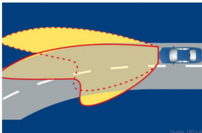
La luz de curva se activa mediante la activación del intermitente o a través de los parámetros de velocidad.
